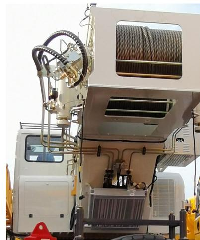
**3** - O sistema de arrefecimento hidráulico possui grande capacidade de troca de calor, garantindo uma operação suave e segura mesmo em locais de clima quente.
