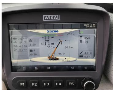
5 - Sistema de monitoramento de pressão nos estabilizadores em tempo real com alarme de alta ou baixa pressão indicando a necessidade de parar a operação por risco de instabilidade. Estas informações são indicadas no monitor do LMI para avaliação do operador em tempo real.
