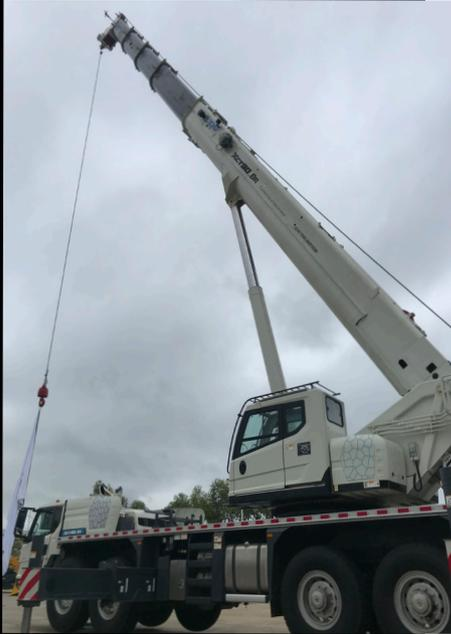
**1** - Com o comprimento total da lança principal de 49m utilizando perfil tipo “U” e fabricado em aço. Utilizando-se as lanças auxiliares I e II o comprimento total é de 66.5m, a altura máxima de levantamento 66m. Com essas dimensões o comprimento da lança é o mais longo entre os concorrentes do mercado da mesma capacidade.
