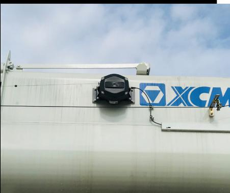
**4** - Equipado com segundo sensor de comprimento no Tele 2 proporcionando novas configurações de tabela de carga.
