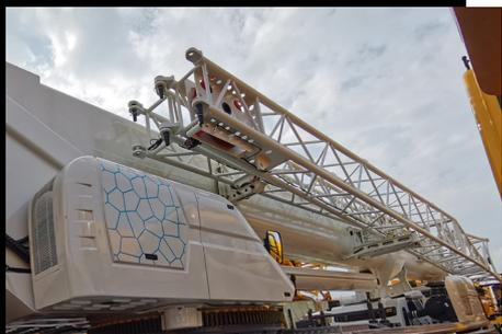
**3** - Dois jibs treliçados com o comprimento de 10.5m jib I e 17.5m jib I + II.
